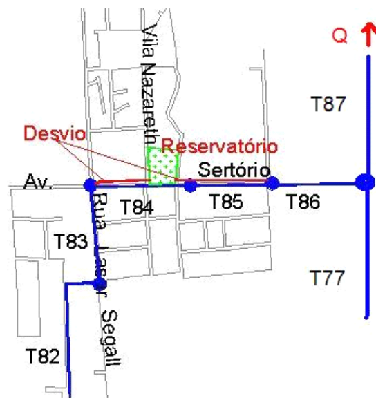
Figura 2. Esquema utilizado para desvio das vazões para o reservatório
